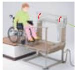
開閉レバーを上下させることで開閉操作が行えます。
